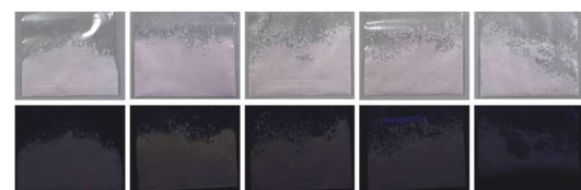
図 9 pH を変えて作製した鱗片状ベーマイトとローダミン B の色素複合粒子の写真 (左より、pH 3、5、7、9、11 の条件で作製、上：蛍光灯下、下：紫外線 (254 nm) 下)
